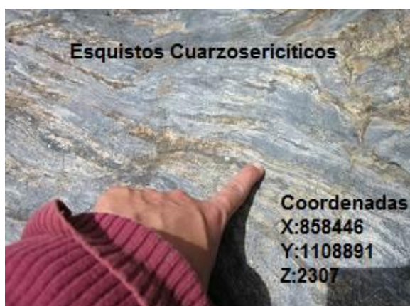
Fotografía 1.1. Esquistos cuarzosericiticos mostrando bandas de cuarzo, con sericita, grafito. Quebrada Peñoles
