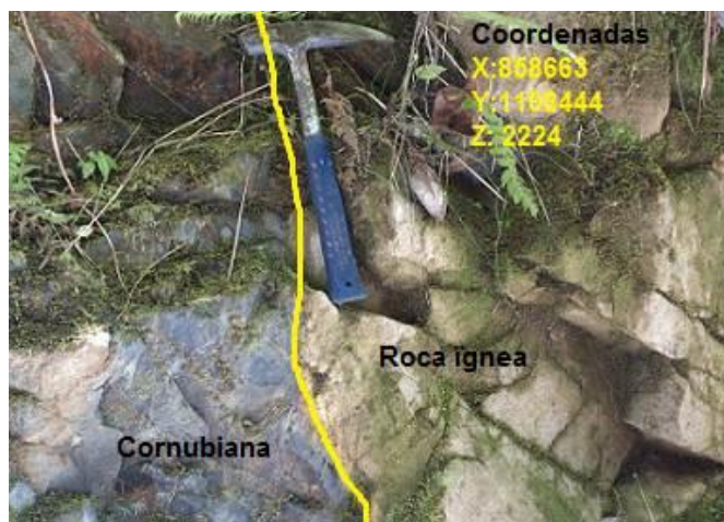
Fotografía 1.20. Aureola de Contacto entre el Batolito de Sonsón y los esquistos cuarzosericíticos del Complejo Cajamarca. Se observa la cornubiana, roca típica de este contacto
