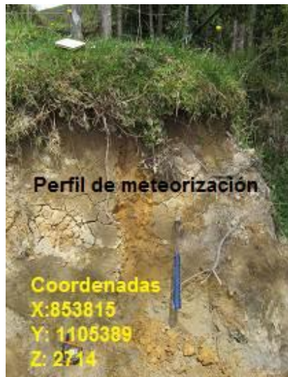
Fotografía 1.34. Perfil de meteorización de la Formación Abejorral. Vía entre Encimadas y Aguadas
