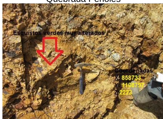
Fotografía 1.9. Esquistos verdes muy alterados con pátinas de óxidos de hierro. Camino entre la vereda Puente Piedras y la terminal de Encimadas
