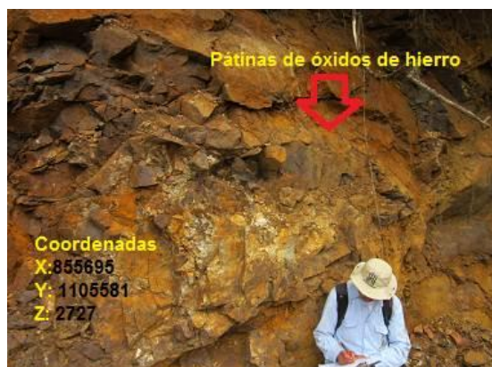
Fotografía 1.8. Esquistos verdes con un alto grado de meteorización. Camino la Quinta, vereda Arenillal de Caldas
