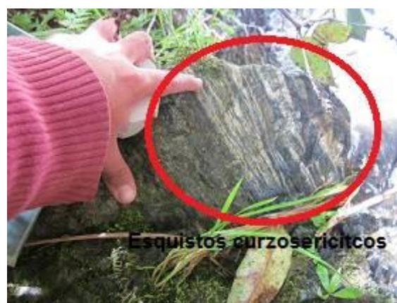
Fotografía 1.2. Esquistos cuarzosericiticos compuesto de sericita, cuarzo. Se observan las bandas de estos minerales. Quebrada Peñoles
